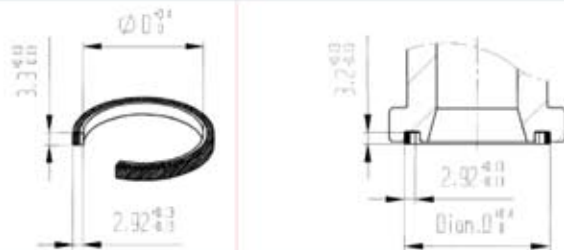
JOINT CARRE POUR BRIDES SAE J518C JOINT SQUARE FOR FLANGES SAE J518C
